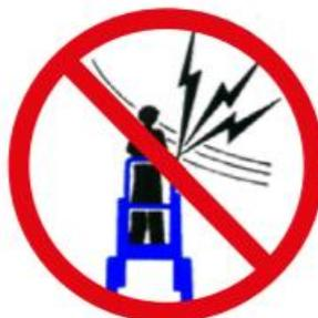
Halten Sie - gemäß den nationalen Vorschriften - einen Sicherheitsabstand zu Stromleitungen ein. Die Plattform lässt ein leichtes Schwanken bei starkem oder böigem Wind zu. Ein Schwanken durch hängende elektrische Leitungen kann eine Gefahr bilden.
