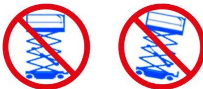
Wenden Sie keine horizontale Kraft oder seitliche Lasten an, indem Sie eine feste oder hängende Last an der Maschine anheben oder absenken. Schieben oder ziehen Sie keine Gegenstände außerhalb der Laufbühne. Die maximal zulässige Querkraft beträgt 18 kg. Verwenden Sie die Maschine **nicht** auf sich bewegenden Oberflächen oder auf einem Fahrzeug.
